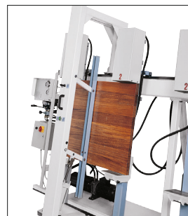
Détail du presseur pneumatique actionné.
