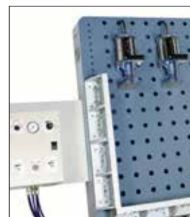
Commande bimanuelle avec gestion à 2 stations indépendantes.
