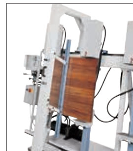
Particolare del pressore pneumatico azionato.
