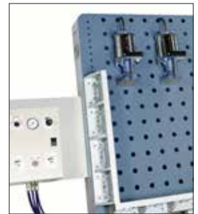
Zweihandsteuerung mit 2 unabhängigen Arbeitsstellen.
