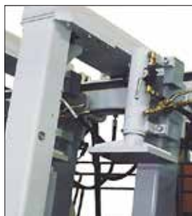
Zylinder und Niederhalter mit Hebel zum unabhängigen Öffnen/Schließen.
