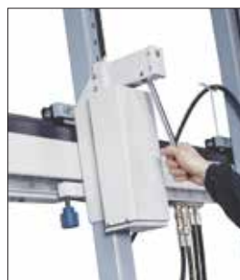
Pratico sistema di sblocco e posizionamento dei cilindri.
