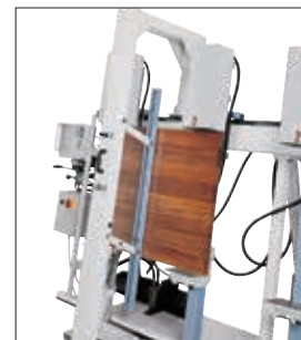
Particolare del pressore pneumatico azionato.
